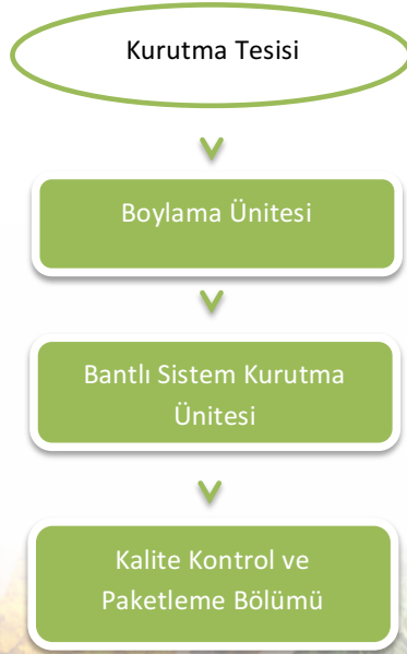
Şekil 15. Kurutma Tesisi Üretim Akış Şeması ve Gerekli Makineler
