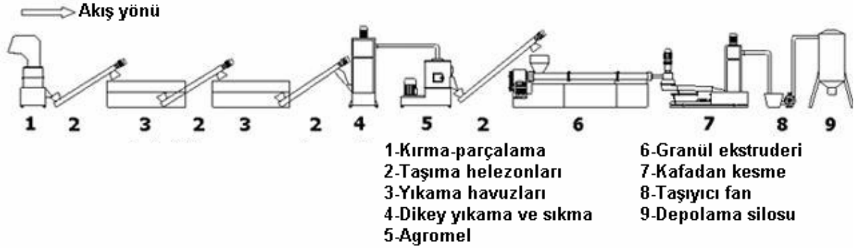
Şekil 2- Geri dönüşüm makinesi üniteleri ve akış şeması
